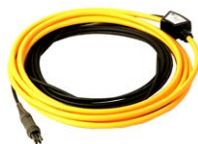
Bobina di Rogowski FS-2 (Ø 1260 mm), livello di uscita 100 mV / 1 A
